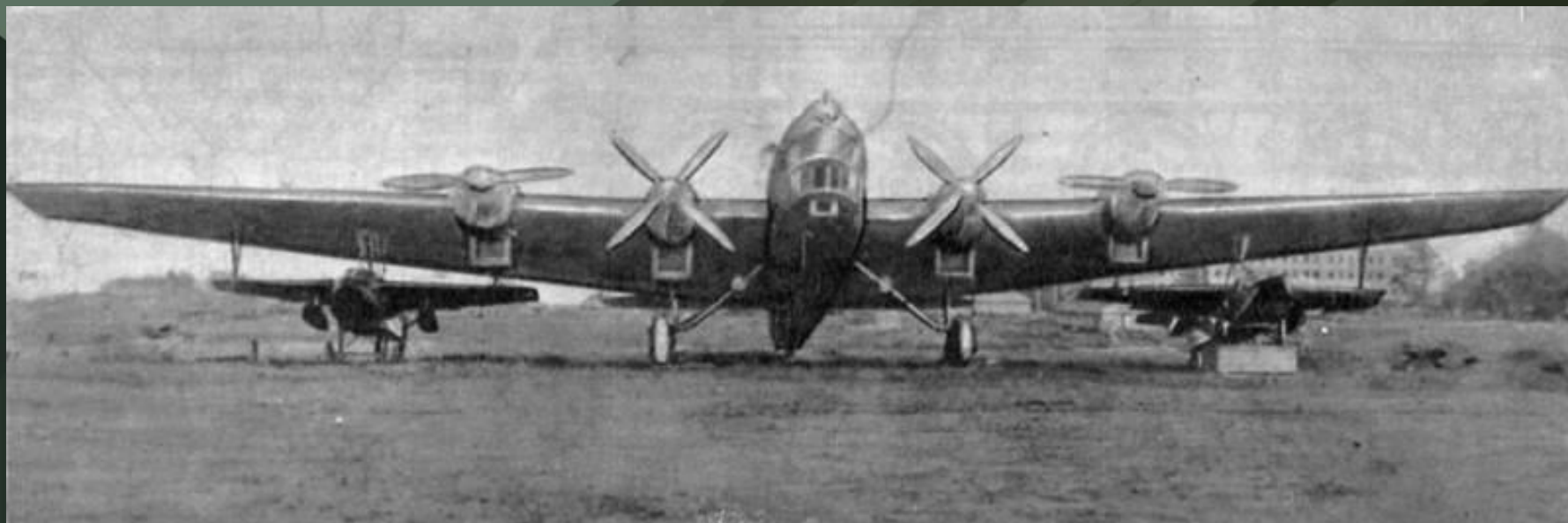
Два ПСН-1 под крылом бомбардировщика ТБ-3
