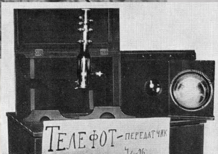
Оптика и передающая трубка телефота, 1926 г.
