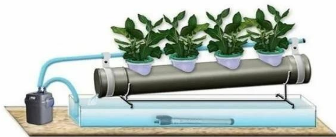
Рис. 9. Система питательного слоя
