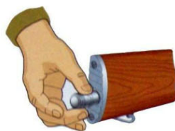
Рис. 2.12. Извлечение пенала с принадлежностью
