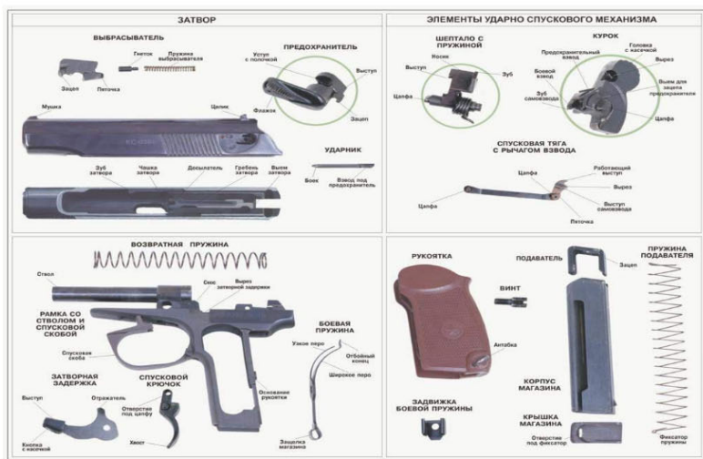
Рис. 3.4. Части и механизмы пистолета ПМ
