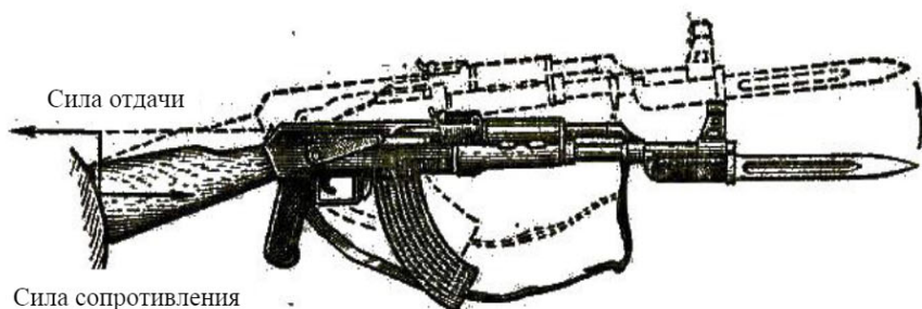
Рис. 1.6. Подбрасывание дульной части ствола оружия при выстреле в результате воздействия отдачи
