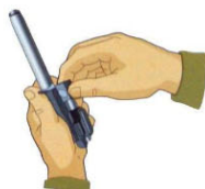
Рис. 2.17. Отделение затвора от затворной рамы
