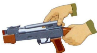
Рис. 2.16. Отделение затворной рамы с затвором
