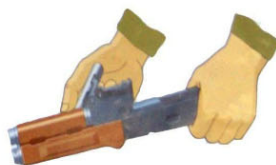
Рис. 2.18. Отделение газовой трубки со ствольной накладкой
