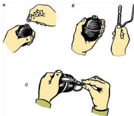
Рис. 4.12. Заряжание ручной осколочной гранаты: а – вывинчивание пробки; б – доставание запала; в – ввинчивание запала
