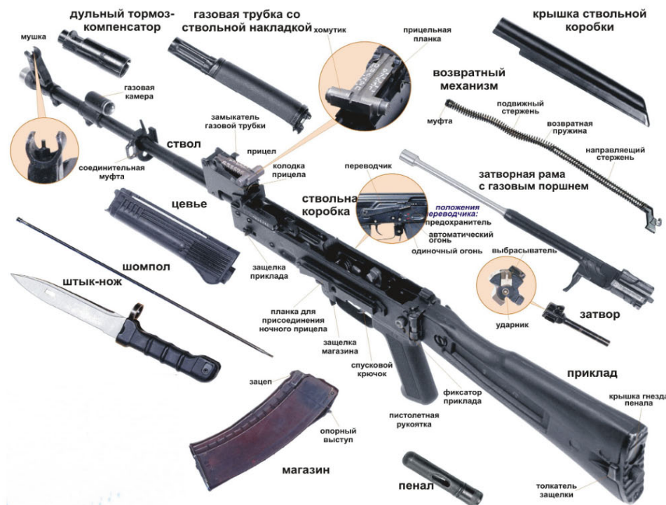
Рис. 2.9. Части и механизмы автомата АК-74М
