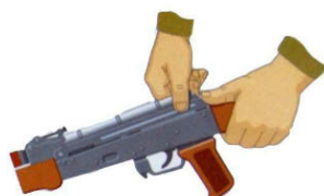
Рис. 2.14. Отделение крышки ствольной коробки
