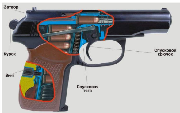
Рис. 3.3. Положение частей и механизмов пистолета ПМ перед выстрелом в момент спуска курка с боевого взвода
