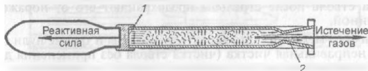
Рис. 3. Образование реактивной силы при действии реактивного двигателя гранаты:
