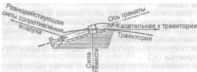
Рис. 10. Действие силы сопротивления воздуха на полет гранаты
