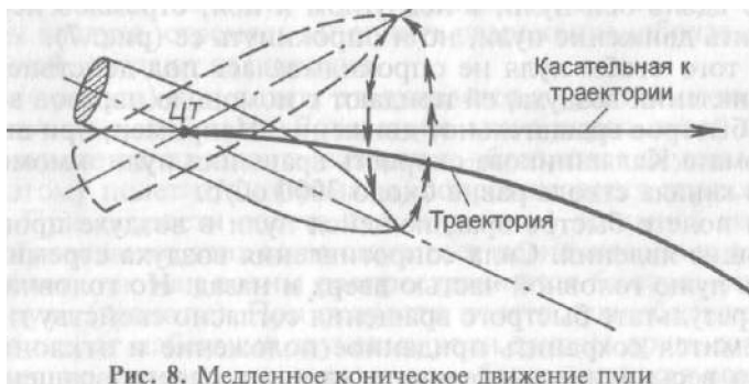
Рис. 8. Медленное коническое движение пули
