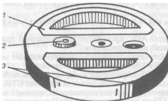
Рис. 146. Диоптр-пробник для проверки прицельных приспособлений гранатометов:
